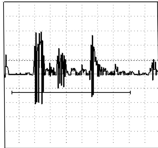
Рис. 8. Отражение импульса от дефекта размером 0,01 мм (слоистая металлическая структура сталь + сталь)
